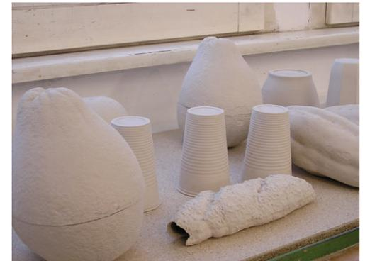
Nach einigen Tagen Trocknungszeit (je nach Dicke) können die Stücke bei 960° rohgebrannt werden.
