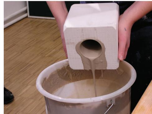
Nach etwa 10-15 min Stehzeit - je nach gewünschter Dicke - wird der restliche Schlicker in einem Schwung zurück in den Kübel gegossen.
