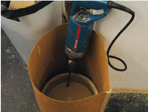
Mit Hilfe eines Quirls in der Bohrmaschine wird aus Tonmehl und Wasser Schlicker von obersartiger Konsistenz angerührt.
