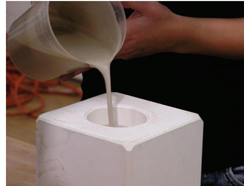
Ein Gefäß mit Ausguss wird mit dem Gießschlicker gefüllt und die Gipsform möglichst in einem Zug angefüllt.
