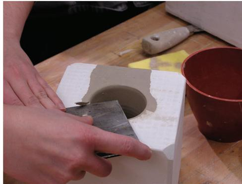
Dann den überschüssigen Ton mit einer scharfen Spachtel oder Ziehklänge flach abschneiden. Immer von der Mitte zum Rand drücken dabei. Darauf achten, dass man nicht in die Gipsform schneidet.
