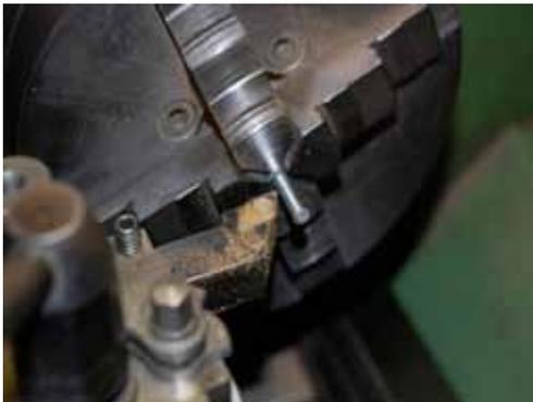
Auf dem Endstück wird ein passendes Außengewinde geschnitten. Dieser Teil kann jetzt in den Paprika geschraubt werden.
