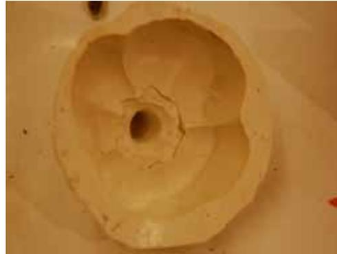
Der Paprika wird entweder mit der Masse M 1470, knetbar, rosa, umhüllt oder wie in diesem Fall mit mehreren Schichten M 4514 gießbar, weiß, beides Fa. Wolf, überdeckt. Die Form sollte einigermaßen stabil sein. Die ausgefranst Ränder werden mit der Schere korrigiert.
