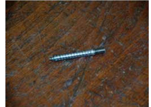
Von einer Schraube wird der Kopf abgesägt und der obere Teil im Durchmesser an das geschnittene Gewinde angepasst (Drehbank)
