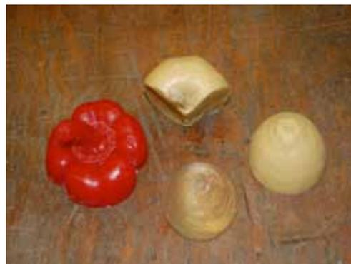
Paprika aus Form gelöst. Die anderen Teile sind aus PU-Harz. Die Rückseite wird am Schleifband eben abgeschliffen.
