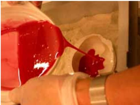
Die Form wird in einen Sandkasten gesetzt und ausgegossen.
