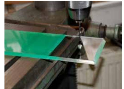
Zunächst wird im Paprika ein Loch gebohrt. Um im rechten Winkel bohren zu können, verwendet man eine plexiglasplatte als Hilfe. In diese wird ein Loch etwa 8mm gebohrt und sie wird wie auf dem Bild am Bohrtisch befestigt.
