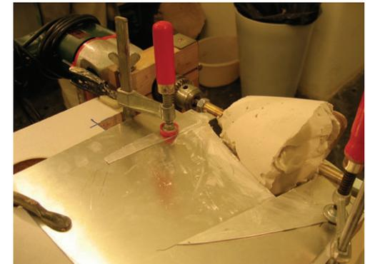
Die Schablone schleift beim Drehen den überflüssigen Gips ab. Beim Trocknen muss die Vorform immer wieder gedreht werden, da sich Gips beim Trocknen ausdehnt. Die Vorform muss noch nicht besonders genau gearbeitet sein, soll aber keine Lücken aufweisen.
