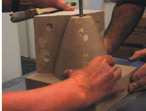
Der Kegel wird leicht gegen den Seitenteil gedrückt. Der Formkasten wird geschlickert und wieder angebaut.
