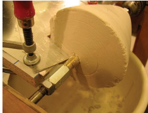
Durch immer neues Ergänzen wird die Form genau an die Schablone angepasst.
