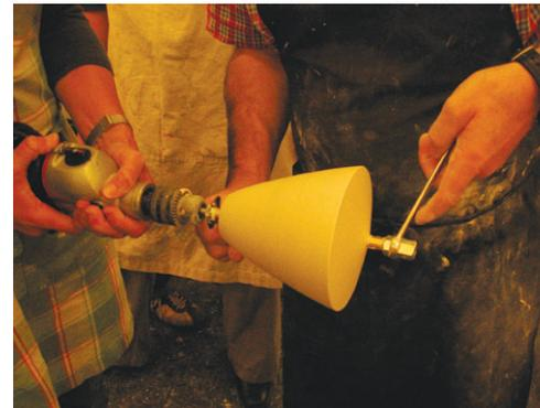
Nach dem Antrocknen wird das Gestänge aus dem Ständer genommen. die Muttern werden gelockert und die Achse wird mit Hilfe der Bohrmaschine (gegenläufig) herausgedreht.
