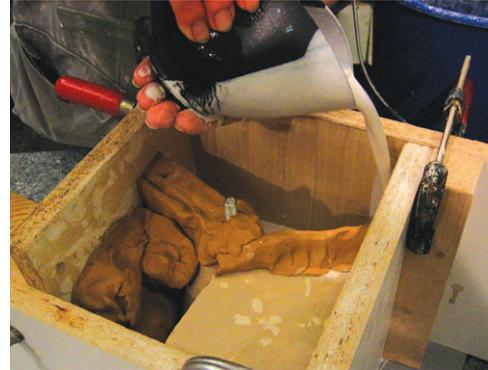
Eine neue Tonwand begrenzt den nächsten Teil. Auf dichten Sitz achten! Der zweite Seitenteil wird ebenso gerade geschliffen, Passer angebracht, und alle Teile werden neuerlich geschlickert. Der Formkasten wird angebaut und der letzte Teil gegossen.
