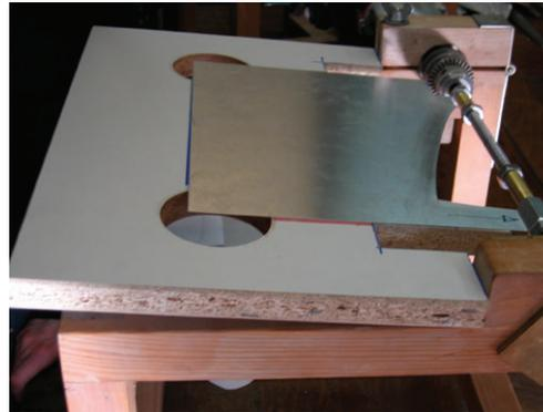
Nach dem Entwurf werden 2 Schablonen angefertigt - Vorschablone und Hauptschablone. Es ist auf eine sorgfältig gefeilte Schnittkante zu achten. Der Tisch wird soweit gekippt, dass das Ende der Schablone genau zur Achsenmitte zeigt.
