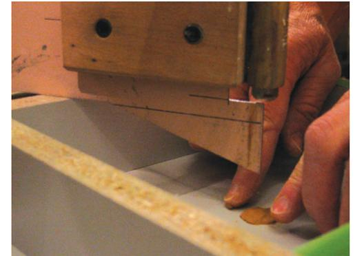
Die Vorschablone wird genau mittig eingerichtet. Am Rand sitzt sie ganz knapp über dem Formenkasten (Ausprobieren, ob sie sich drehen läßt!).
