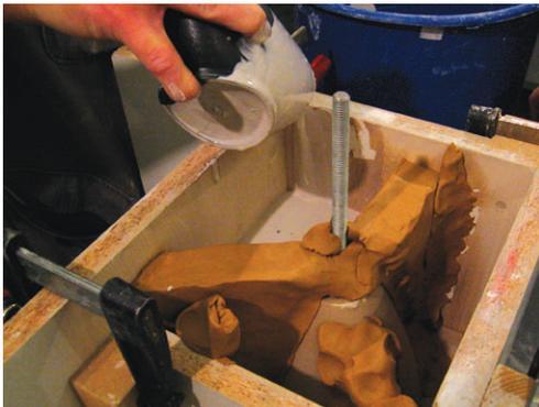
Der Formkasten wird geschlickert und zusammengebaut. Auf dichten Sitz besonders im zu gießenden Drittel muss man achten. Der Prototyp wird nach hinten noch mit Tonresten abgestützt, um Verrutschen zu vermeiden. Eher flüssiger Gips wird über die Randseite eingefüllt.
