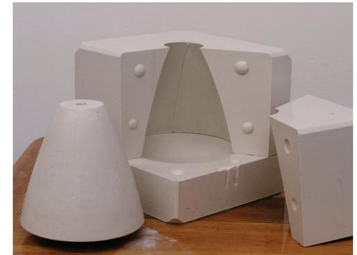
Rundum werden Passmarken angebracht zum leichteren Zusammensetzen und die Form geschlossen zum Trocknen aufgestellt.
