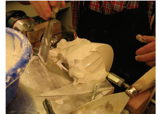
Während des Drehens wird neuer Gips aufgebracht, der nicht zu fest sein sollte zwecks guter Verbindung mit der Vorform.
