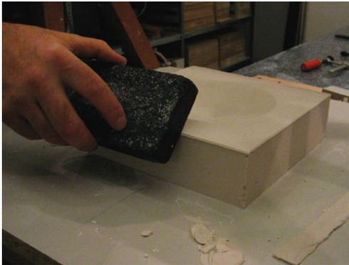
Nach dem Antrocknen des Bodens und dem Entfernen des Formenkastens wird der Boden vorsichtig unter fließendem Wasser von Schlicker gereinigt. Mit dem Schleifstein werden die scharfen Kanten entfernt. Die Endbearbeitung der Kanten erfolgt später.
