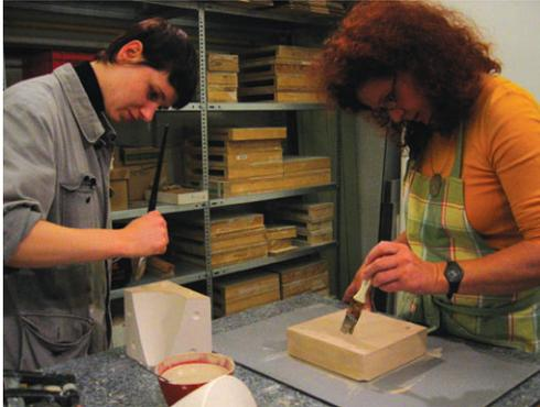
Alle 3 Teile werden wieder geschlickert und genauestens zusammengebaut.
