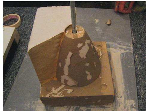
Formkasten und Ton werden entfernt. Unter fließendem Wasser wird der Schlicker abgewaschen, und der erste Seitenteil an den inneren Seitenflächen eben geschliffen.
