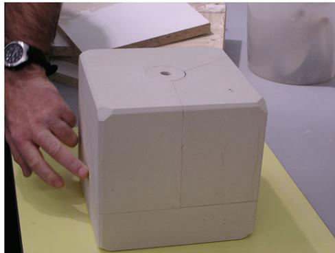
Ecken werden leicht abgeschrägt, die Höhe wird bis zur Höhe des Prototyps abgeschliffen. Dann kann die Form unter fließendem Wasser auseinander genommen werden. Alle Innenkanten werden bis vor die Form leicht gebrochen. Achtung: nicht die Gußnähte schleifen!
