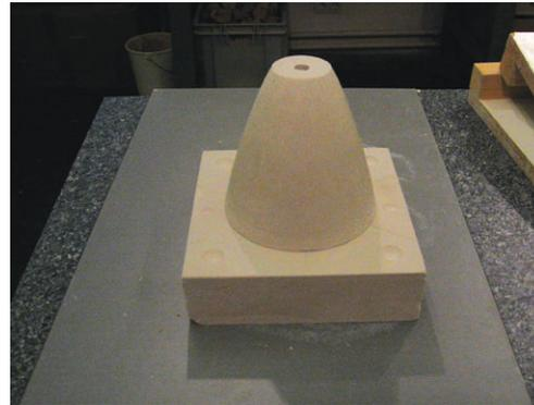
Mit Löffel oder Bohrmaschine werden Vertiefungen als Passer angebracht. Der Prototyp wird genau in die Mitte gesetzt, nachdem der Boden geschlickert wurde. Der Rand wird mit Schlicker sorgfältig abgedichtet.
