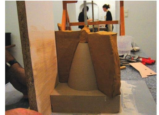
Am Oberteil des Drehkörpers wird die 120° - Dreiteilung markiert und mit Hilfe des Formenkastens und der Drehschablone werden 2 stabile Tonwände eingepasst. Das Ganze ist etwas höher als der Drehkörper, um ein Überlaufen des Gipses zu vermeiden.
