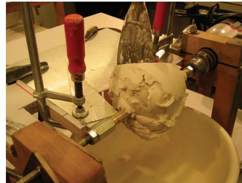
Der Vorgang wird so lange wiederholt, bis der Gipskörper bis zur Schablone reicht. Fehlende Stellen werden sorgfältig ergänzt.
