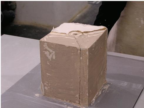
Nach dem Entfernen des Formkastens werden zunächst alle Außenflächen und Kanten mit dem Schleifstein bearbeitet.
