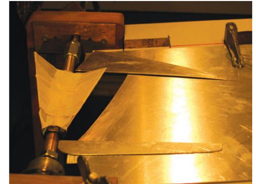
Boden und obere Öffnung des Gefäßes werden durch separate Blechstücke definiert. An die Schraubenmuttern werden 3 Flügel als Mitnehmer für den Gips angeschweißt. Das Ganze wird mit Tesakrepp umwickelt, um ein Anhaften des Gipses an der Achse zu verhindern.
