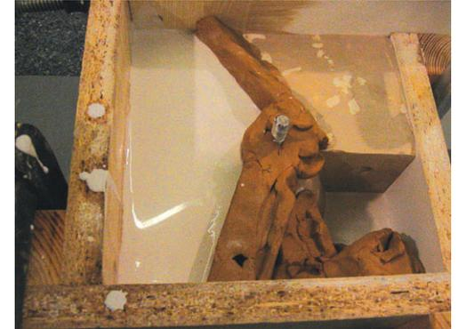
Der zweite Seitenteil wird bis zur selben Höhe gegossen. Der Gips sollte eher flüssig sein. Klopfen hilft gegen Luftblasen.
