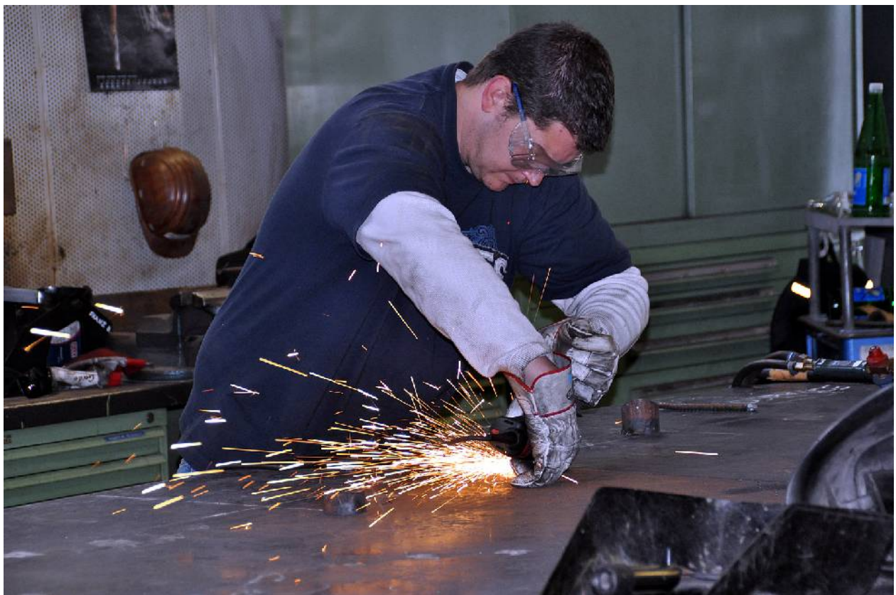
Abb. 13 Zurichten mit dem Winkelschleifer.
