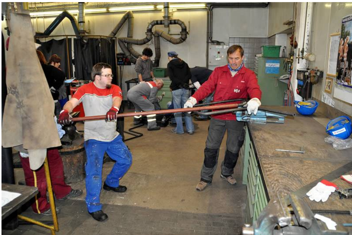
Abb. 15: Ausrichten der gebogenen Form.
