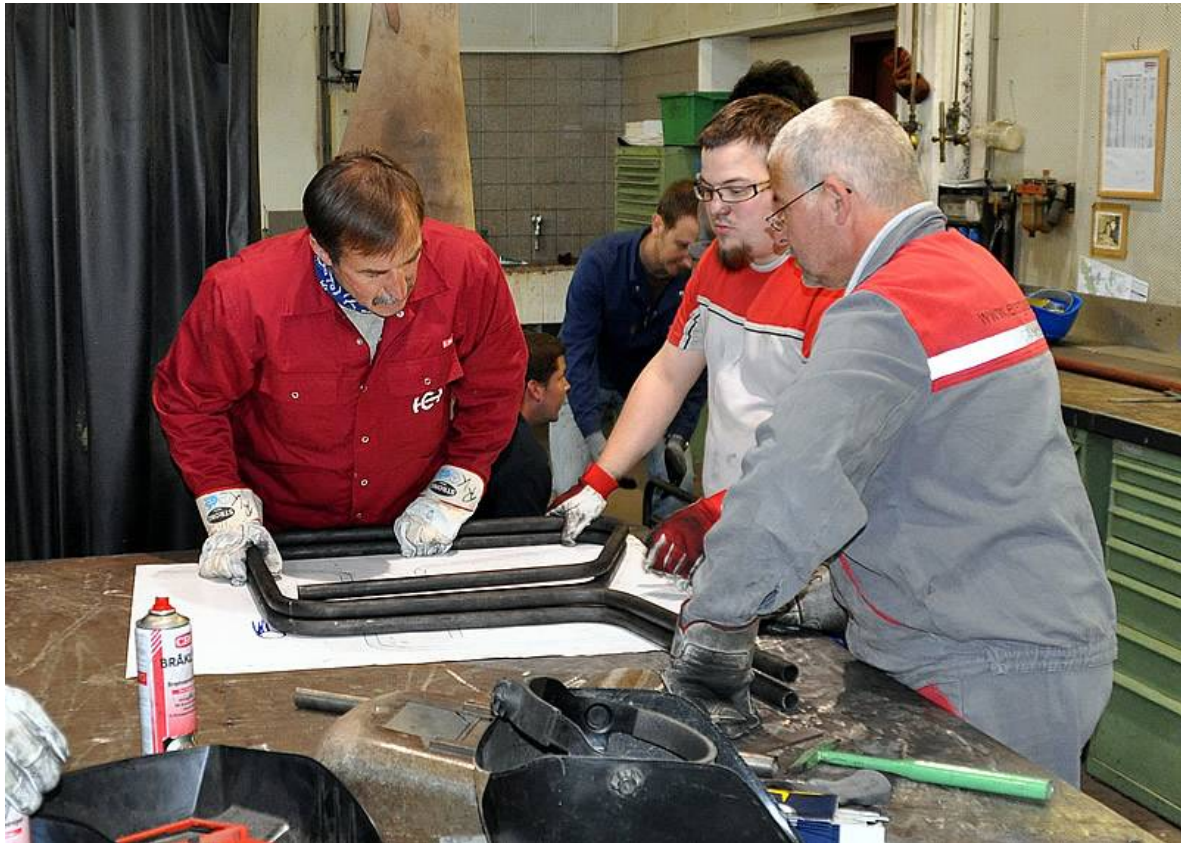
Abb.14: Überprüfen der Formen auf ihre Passgenauigkeit und ihre Übereinstimmung mit dem Entwurf.
