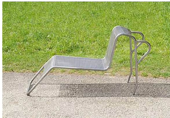
Abb. 30, 31: Entwurf und Ausführung: Konrad Brandl. Diese Sitzgelegenheit ist ein Wandelmöbel. Um 90 Grad gedreht, wird aus dem Sitz- ein Liegemöbel. Werkstoffe: Stahlrohr und Lochblech.
