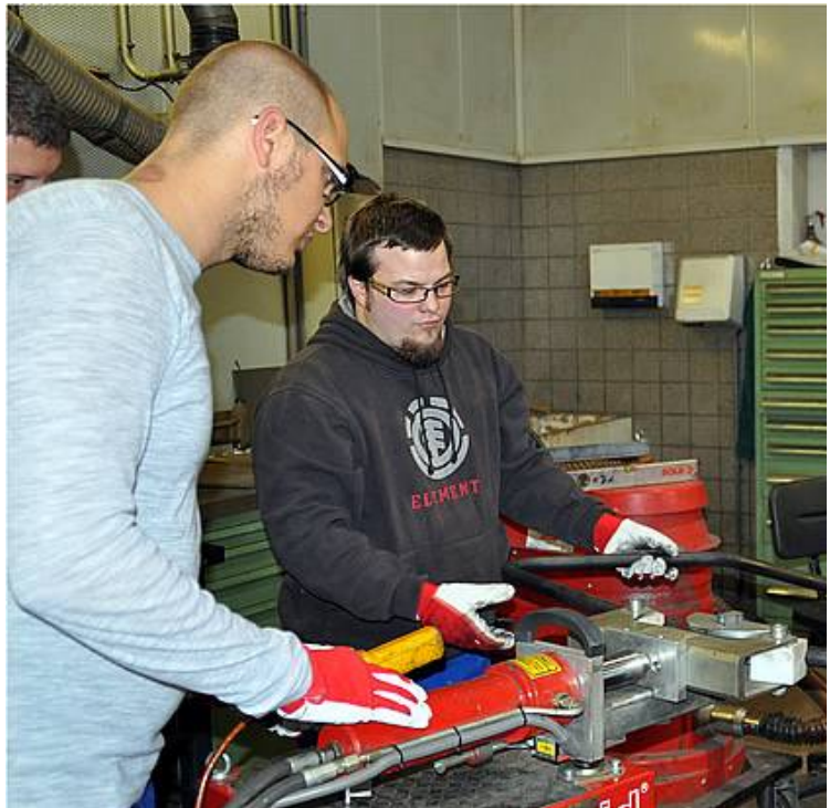
Abb. 12: Biegen eines Stahlrohres mit der hydraulischen Biegemaschine.
