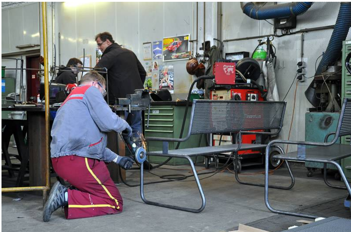
Abb. 17: Bearbeiten der Form mit dem Winkelschleifer.
